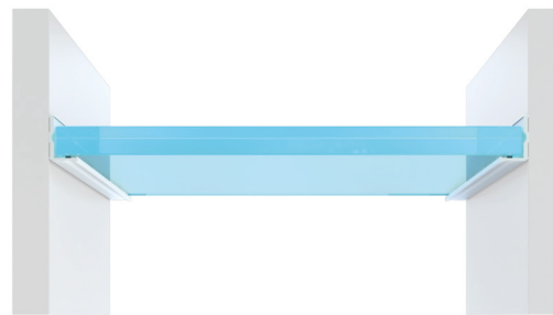
Schemat montażu profilu LED F do półki szklanej.
